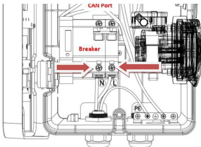
Figura 13 - Connessione dei cavi AC di uscita (2)
