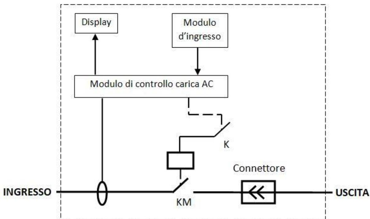
Figura 5 - Funzionamento schematico della stazione di ricarica
