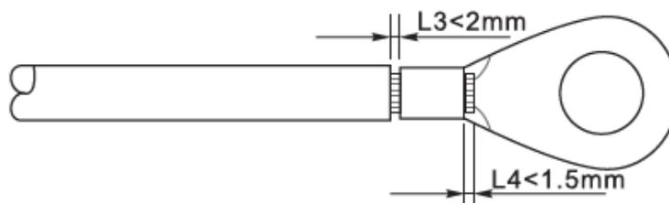
**Figura 10 - Preparazione cavo di terra (2)**
