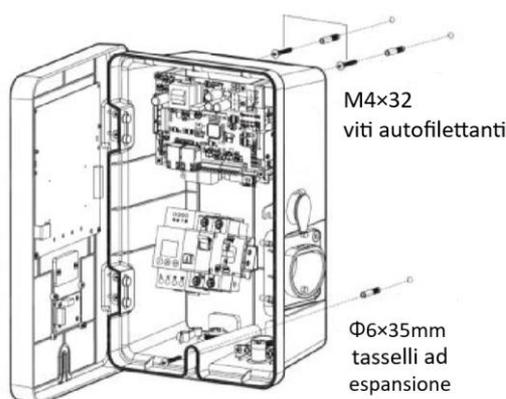
Figura 16 - Posizionamento viti per montaggio a parete
