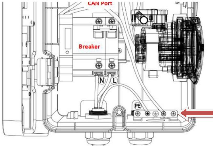
Figura 11 - Collegamento del terminale di terra
