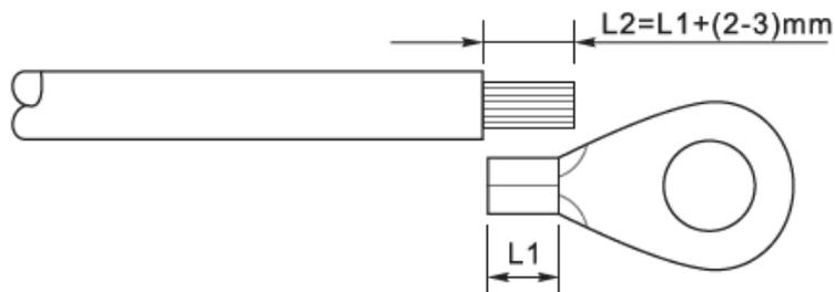
**Figura 9 - Preparazione cavo di terra (1)**
