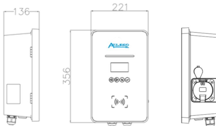
Figura 4 - Vista frontale, laterale della stazione di ricarica
